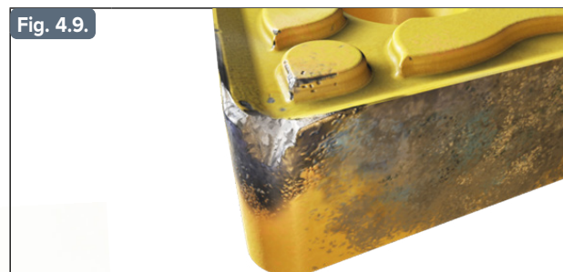
Fallo catastrófico (rotura) del filo de corte
