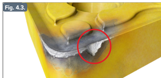
Desgaste del flanco localizado (en entalla o por entalladura)
