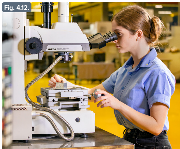
Comprobación del desgaste de una herramienta mediante microscopio computerizado en el Centro Técnico de ISCAR
