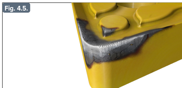
Astillamiento del Filo de Corte
