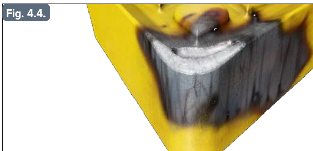
Desgaste frontal en forma de cráter
