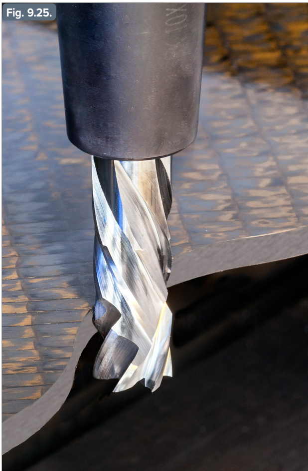
Fig. 9.25. Fresa de metal duro integral con filos de corte helicoidales a derechas y a izquierdas para el mecanizado de composites.
