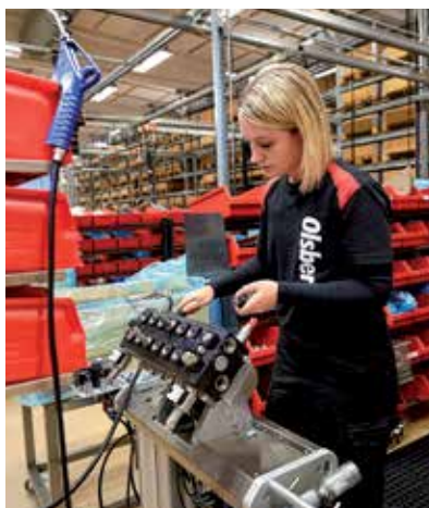
Smuts påverkar funktionen i hydrauliken. En enda liten spåna kan orsaka läckage. Här arbetar Sandra Svensson med montering och slutprovning.
