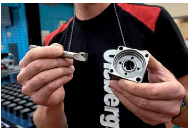
Här är ett av verktygen från Iscar som används till invändig svarvning.
