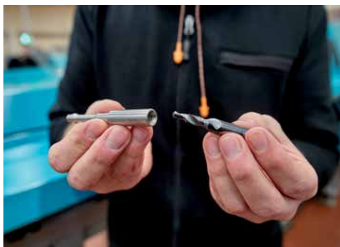
Ny special-stegborr från Iscar testas i produktionen av kolstänger.
