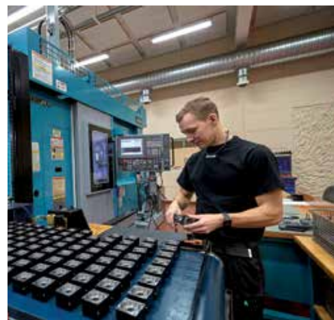
Johannes Wikerfelt kontrollmåtar positionerarhus som tillverkas i den automatiserade svarvstationen.
