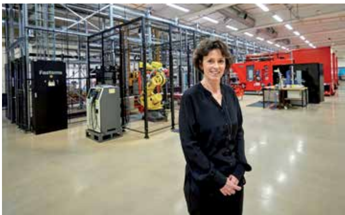
Christina Henriksson visar företagets automatiska FMS-anläggning. En robot laddar paletter med ventilämnen som sedan förs till en ledig bearbetningsmaskin.
