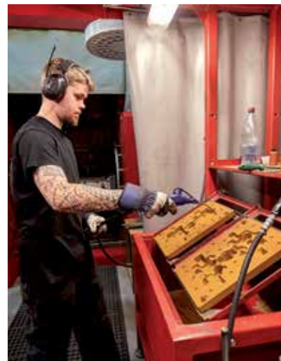
Innan gjutmassan fylls på i skalet laddas skalen med kärnor som formar ventilens invändiga kaviteter.
