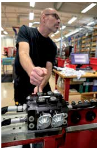
Här provtrycker Kent Henriksson ett färdigmonterat ventilblock.
