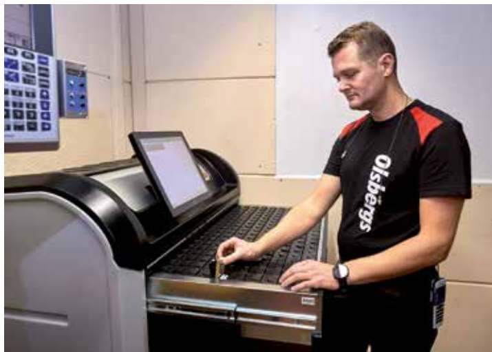
Olsbergs har investerat i ett automatiserat Matrix verktygslager från Iscar med 498 låsta fack. Systemet sköter automatiskt alla verktygsbeställningar, berättar Robert Johansson.
