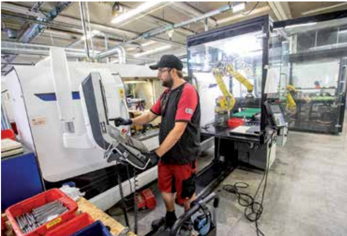
Hos Gloab finns nio CNC-styrda slipmaskiner varav fem är robotstyrda.
