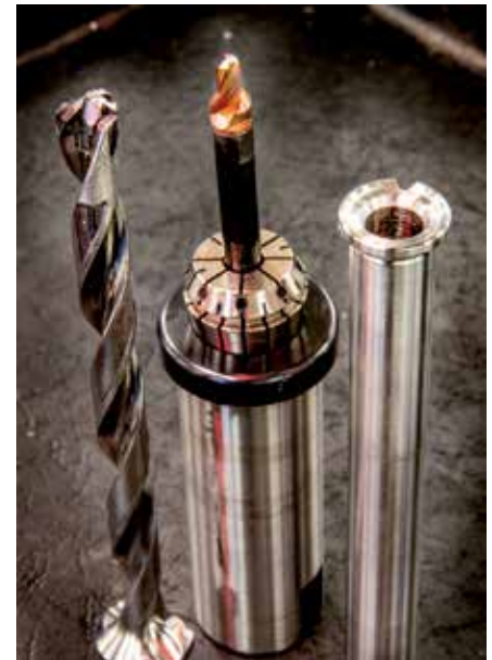
Iscars special MultiMaster för bearbetning av kolvstäng och Iscar SumoCham för håltagning. Tidigare användes tre olika verktyg.
