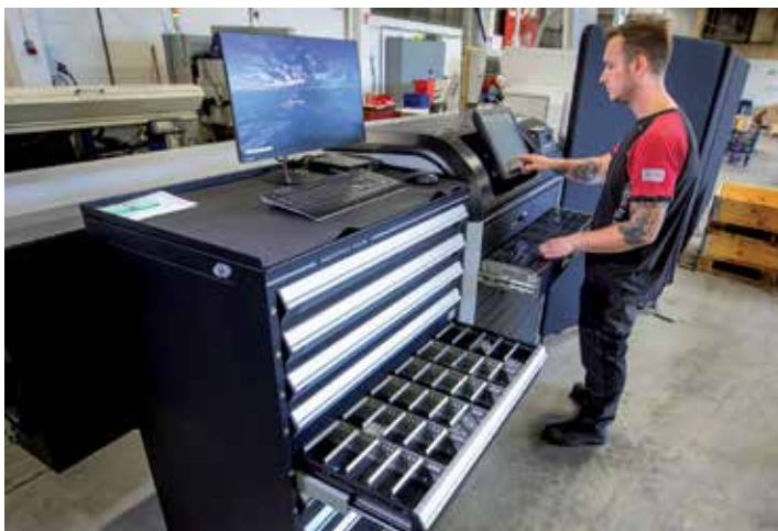
Gloab har två verktygslager, Matrix Maxi och den lite enklare versionen Matrix DLS. Båda lagerenheterna styrs via en gemensam pekskärm.
