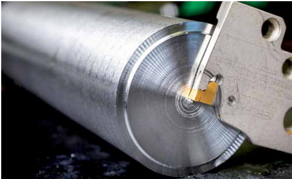
Med nya Iscar-skäret TAGHF för högmatningsavstickning, minskade man avstickningstiden från 22 till 9 sekunder!
