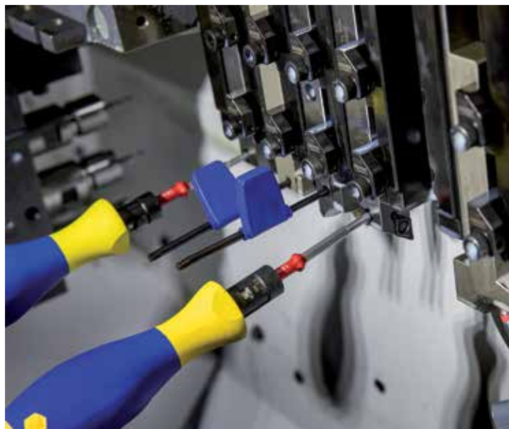
När Iscar löser problem. Med en vanlig torxnyckel kan skäret lossas och bytas direkt i maskinen – utan inmätning.
