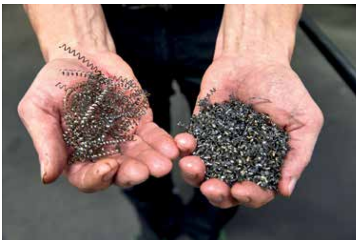
Jonny ger ett konkret exempel på vad som menas med förbättrad spånkontroll. De små fina spånorna i handen till höger på bilden kommer från Iscars CXMG-skär.
