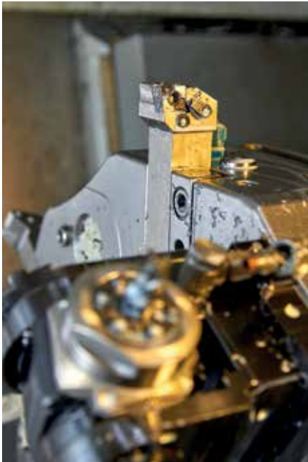
Det dubbelsidiga positiva CVMG-skäret har 4 skäreugar, förbättrad spånkontroll och högre produktivitet.
