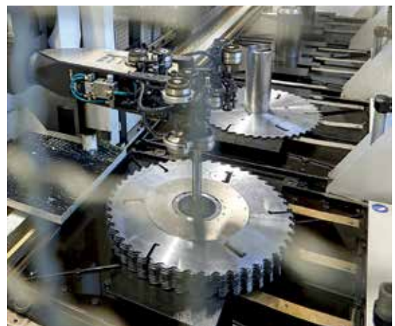
Sågklingor som ska slipas, riktas, tandas om och få ojämnheter justerade.
